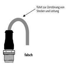
bei der Verwendung von Kabelbindern ist darauf zu achten, dass diese nicht in die Leitung einschneiden oder sogar die Leitung deformieren. So vermeiden Sie:
