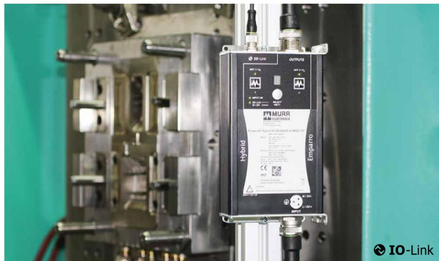
Das innovative Schaltnetzgerät Emparro67 Hybrid ist ein Multitalent mit vielfältigen Stärken: Es verlagert nicht nur die Stromversorgung aus dem Schaltschrank ins industrielle Feld, mit zwei integrierte Kanälen zur 24-VDC-Lastkreisüberwachung überwacht es zusätzlich die Ströme und sorgt damit für hohe Betriebssicherheit. Eine IO-Link-Schnittstelle ermöglicht eine umfangreiche und transparente Kommunikation.
