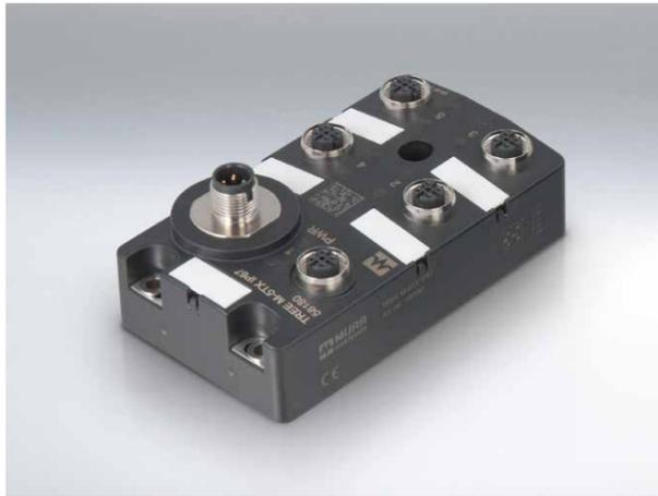
Die Switches sind kompakt und vollvergossen. Dadurch sind sie robust und langlebig. Sie können im industriellen Feld eingesetzt werden, in schmutziger und rauer Umgebung. Die M12-Anschlussstechnik ist wasserdicht in der Schutzart IP67 ausgeführt. Durch die Verlagerung der Netzwerktechnologie ins Feld wird kostbarer Platz im Schaltschrank eingespart.
