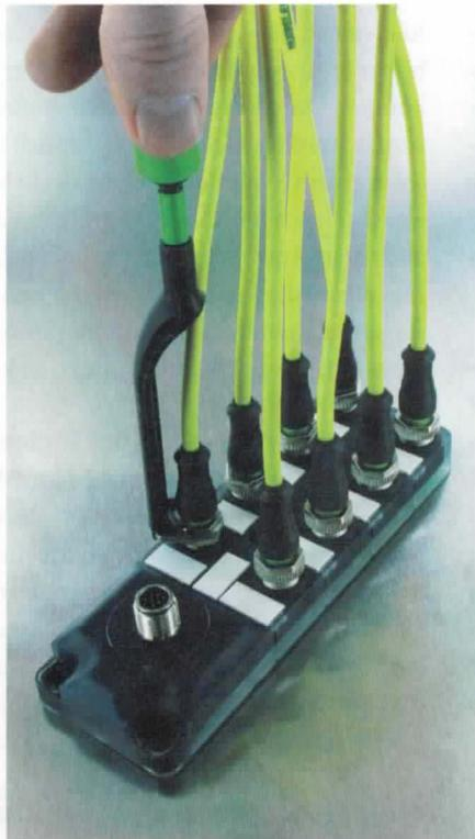
▲ Ein M12-Stecker hat einen O-Ring, den der Kunde fest anziehen muss. Deshalb bietet Murrelektronik einen Drehmomentschlüssel für 0,6 Nm an. (Bild: Murrelektronik)
